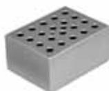
For 20 x 0.5 ml PCR or Microcentrifuge Tubes
